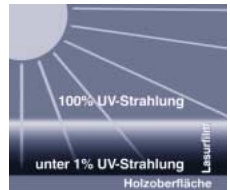
2-Phasen-UV-Schutz hält durch eine spezielle Bindemittel-Kombination den Strahlendurchgang unter 1%.
