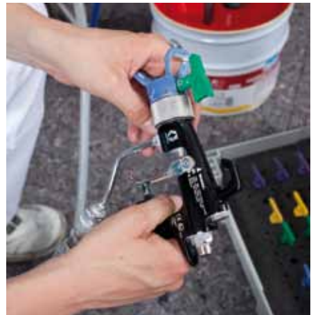
3. Für einen optimalen Farbauftrag ist die richtige Düse entscheidend.
