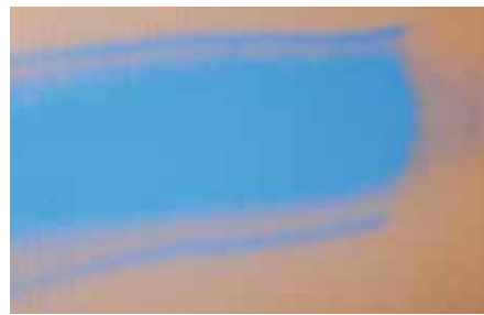
Das Spritzbild zeigt unschöne Randstreifen – die Folge von Geräte-Verschleiß oder falscher Einstellung.
