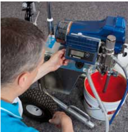
4. Die richtige Druckeinstellung ist ausschlaggebend für einen präzisen Farbauftrag.
